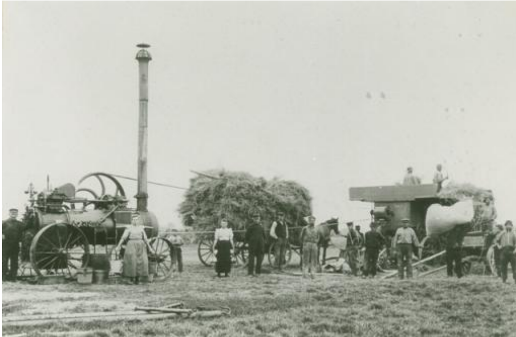
Een dorsmachine aangedreven door een stoommobiel (rond 1895-1900) bij het gehucht Panser tussen Zoutkamp en Vierhuizen. Bron/foto: H. Hes, collectie RHC Groninger Archieven.
